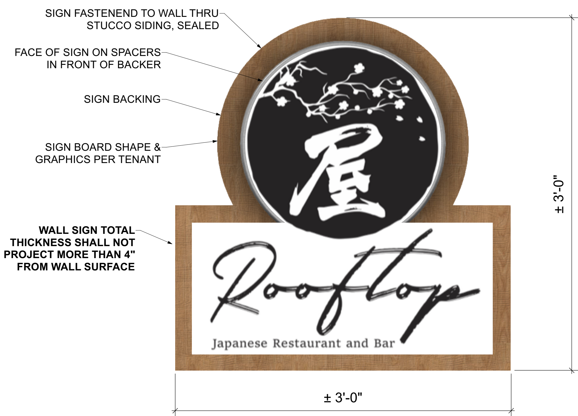
6 WALL SIGN ELEVATION - ROOFTOP Scale: ACTUAL SIZE
